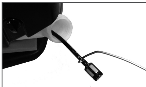
Рис. 11 Обслуживание топливного фильтра
